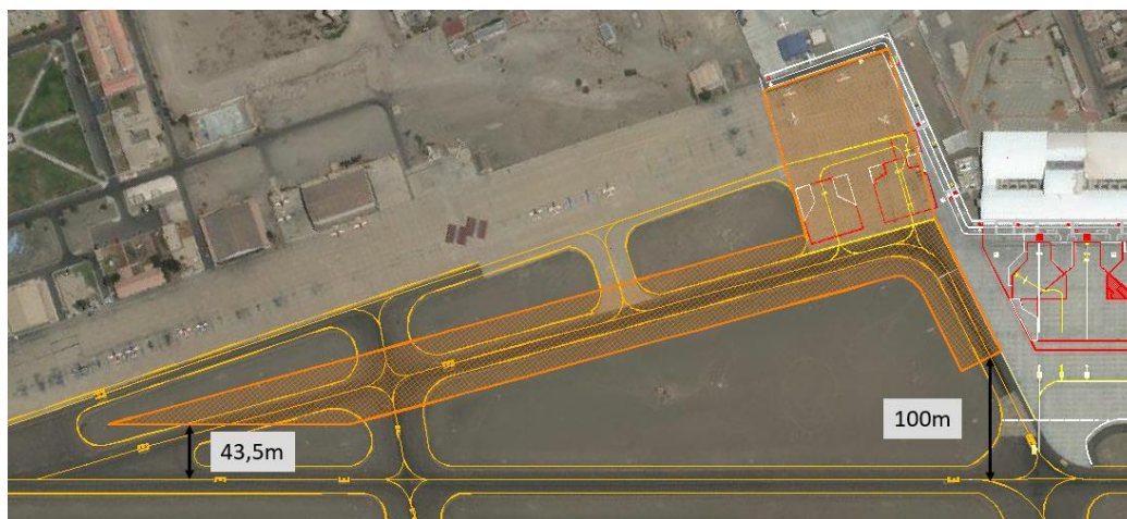
Imagen 48. Vista Fase 3 con trabajos en “Alfa-1” finalizados a 100m del eje de “Eco”
