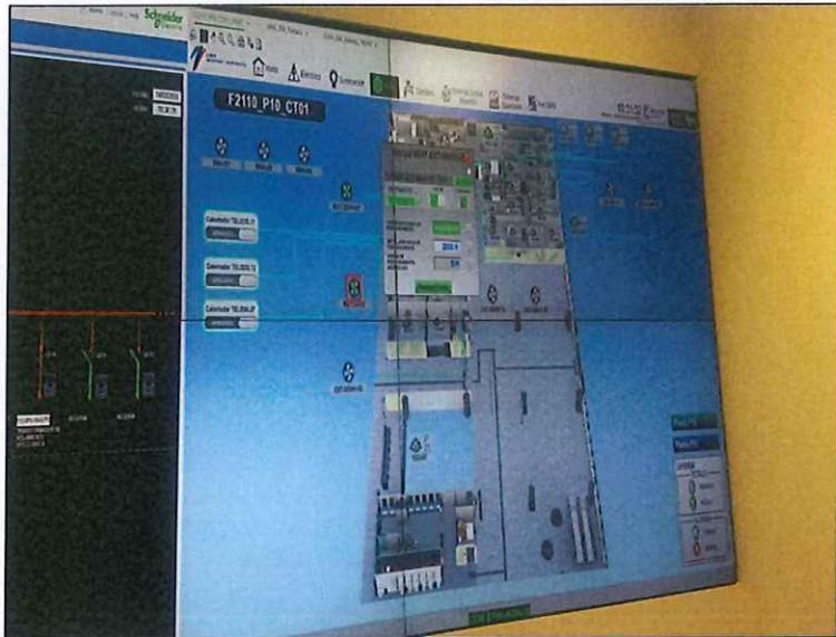
Foto 05 – Terminal de pasajeros procesador (2110) en la Sala CCM (Centro de Control de Mantenimiento) se verifico el avance de integración del BMS del Sistema de Administración de Edificios.
