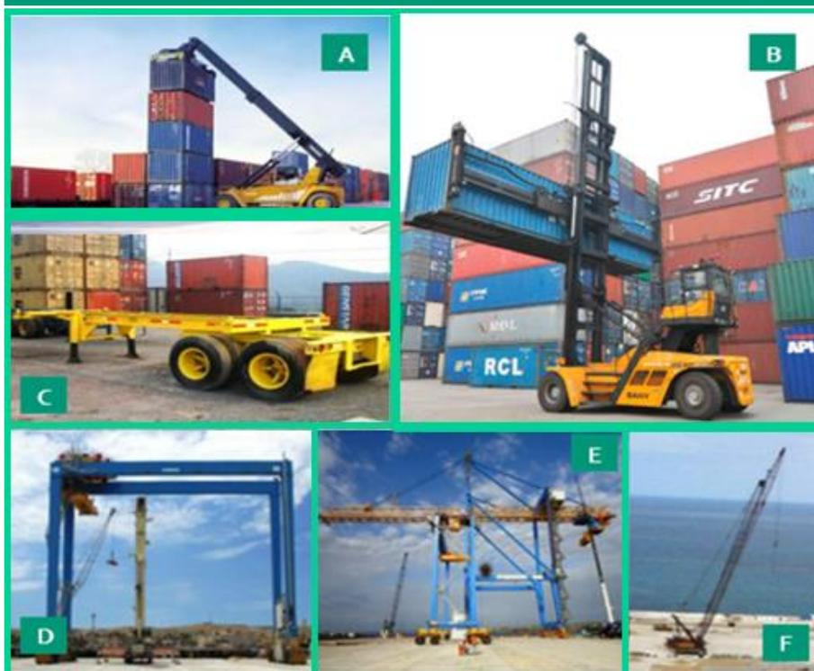
Nota: (A) Reach Stacker, (B) Elevador de contenedores vacíos, (C) Chasis para contenedores (D) Grúa pórtico de patio RTG, (E) Grúa pórtico de muelle STS, (F) Grúa móvil de muelle.
