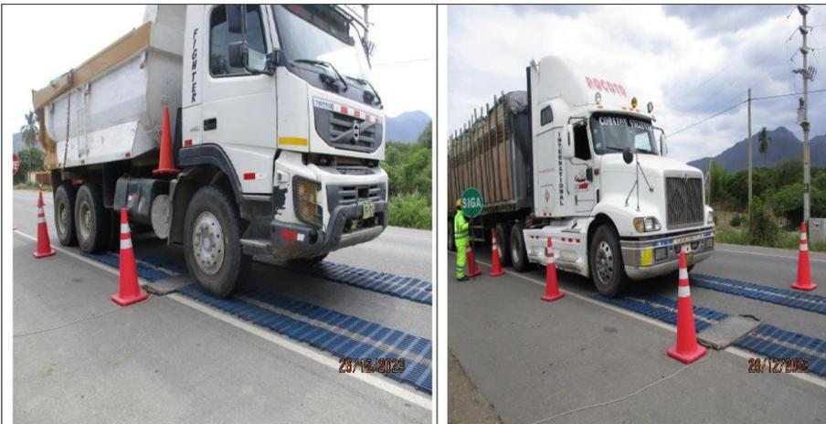
*Pesaje Móvil "Canchaque": Vehículo pasando a una velocidad de 5 km/h para obtener el rango óptimo de pesaje.*
