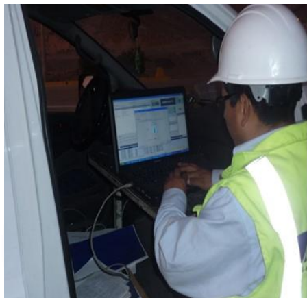
Medición de la Rugosidad (IRI) de la calzada con perfilómetro laser
