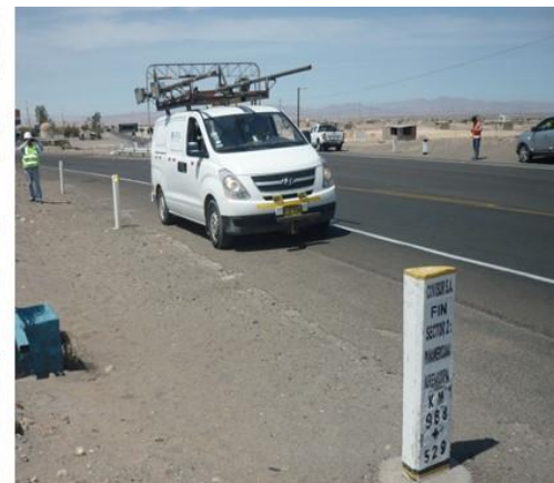
Medición de la Rugosidad (IRI) de la calzada con perfilómetro laser
