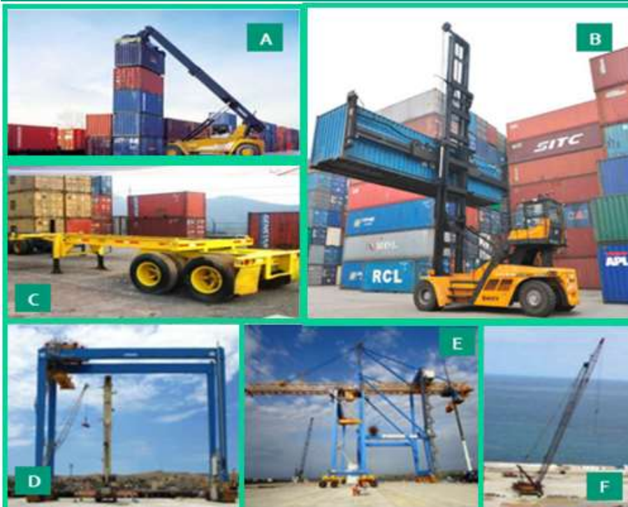
(A) Reach Stacker, (B) Elevador de contenedores vacíos, (C) Chasis para contenedores (D) Grúa pórtico de patio RTG, (E) Grúa pórtico de muelle STS (F) Grúa móvil de muelle. Fuente: Logismarket. Neptunia. Mota Engil.
