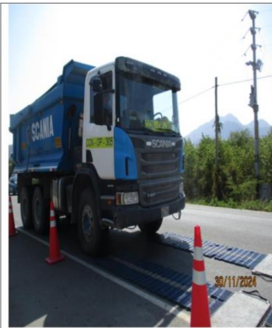
Pesaje Móvil "Canchaque": Vehículo pasando a una velocidad de 5 km/h para obtener el rango óptimo de pesaje.
