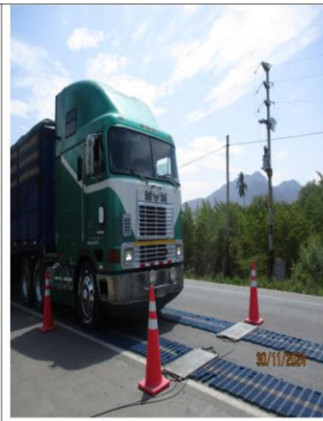
Pesaje Móvil "Canchaque": Vehículo pasando a una velocidad de 5 km/h para obtener el rango óptimo de pesaje.
