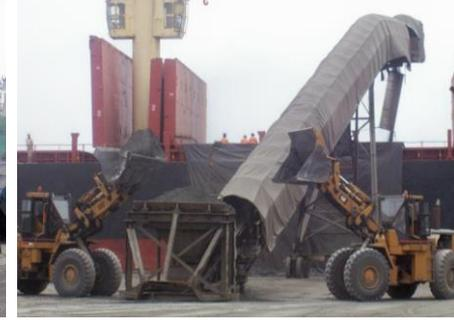
Transporte por camiones con tolva cerrada y pistones, embarque por descarga desde camión para alimentador con faja portátil y móvil cerrada (hasta el 2014)
