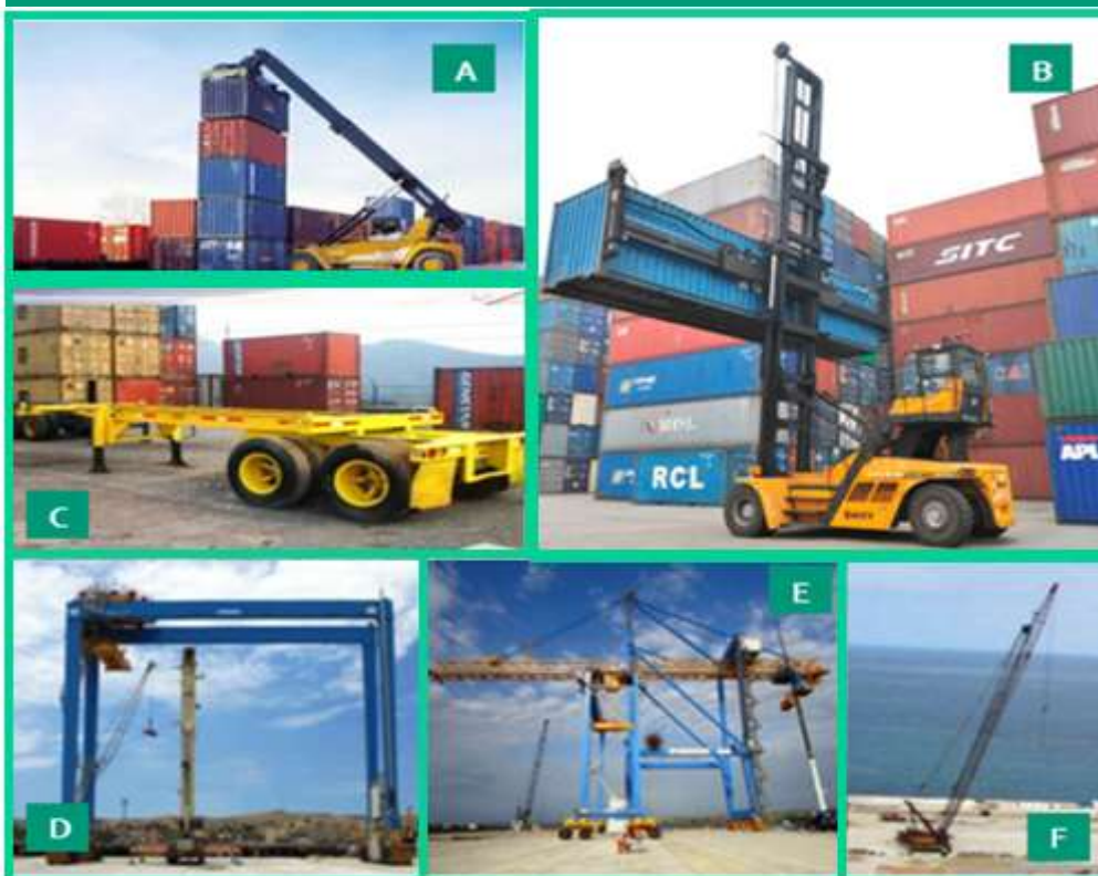
(A) Reach Stacker, (B) Elevador de contenedores vacíos, (C) Chasis para contenedores (D) Grúa pórtico de patio RTG, (E) Grúa pórtico de muelle STS, (F) Grúa móvil de muelle.
