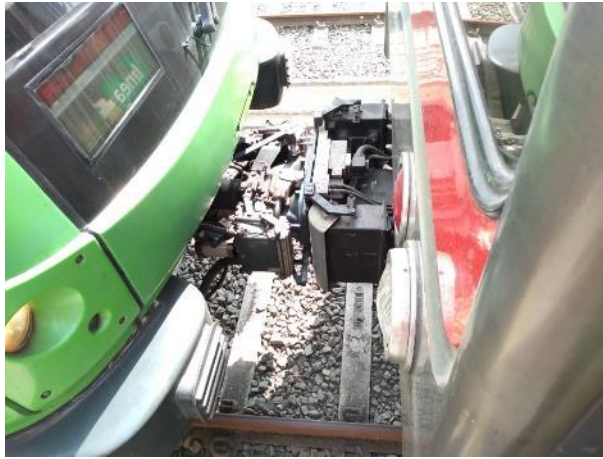
Pruebas de acople trenes 6 coches (ALSTOM-ALSTOM) (ANSALDO-ALSTOM)
