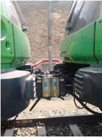
Pruebas de acople trenes 6 coches (ALSTOM-ALSTOM) (ANSALDO-ALSTOM)
