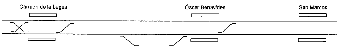
Esquema H.6.3-1. Ubicación de tercera vía entre Carmen de la Legua y Oscar Benavides
