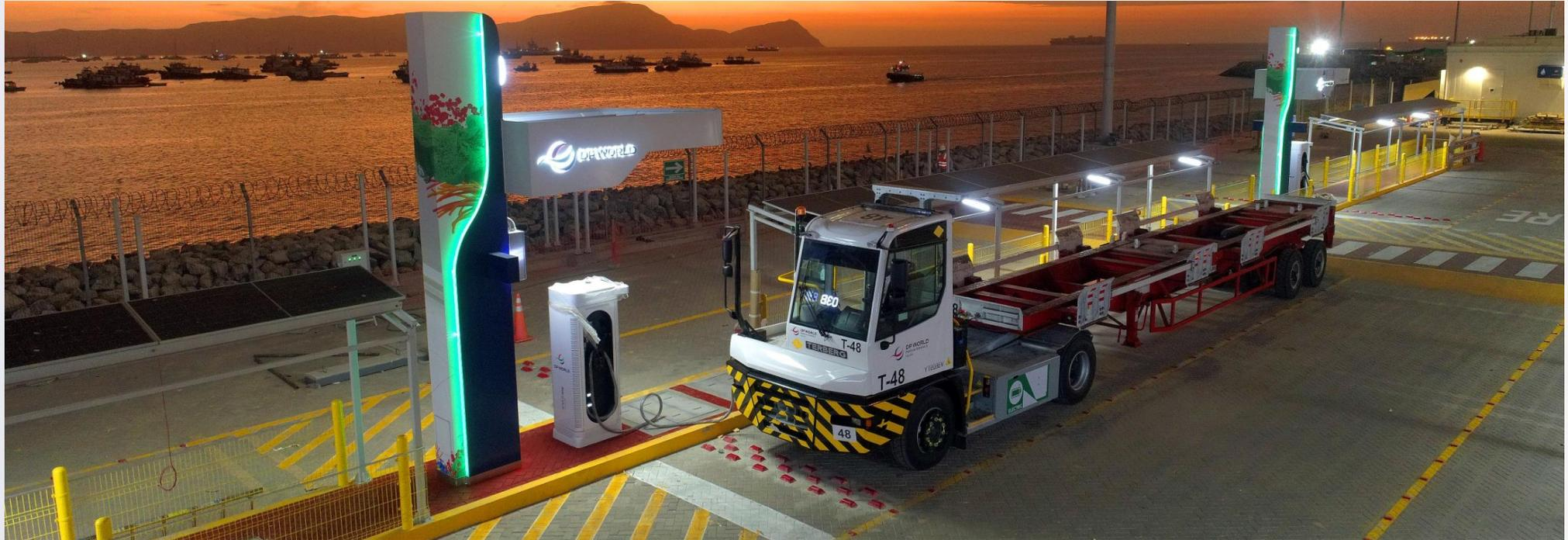
En 2024 inauguramos una estación de carga con 10 cargadores rápidos dobles para la recarga de 20 ITV eléctricos. Este año ejecutaremos la expansión de la estación de carga con 06 nuevos cargadores rápidos
