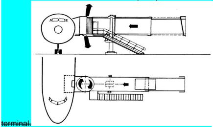
Extensible. Uno de los extremos de la pasarela telescópica va unido al edificio terminal, mediante articulación, y el otro se sostiene sobre dos ruedas gemelas orientables, accionadas por motor. La pasarela se orienta hacia la aeronave y se alarga hasta alcanzar la puerta de la misma. El extremo que se acopla a la aeronave puede levantarse o bajarse apreciablemente, lo que permite atender desde la pasarela a aeronaves que tienen distintas alturas de cabina.
