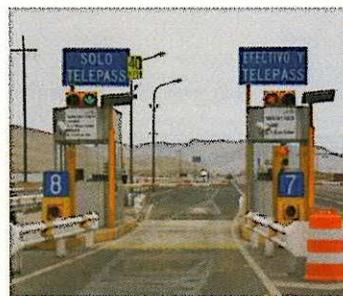
El Telepass consiste en el cobro de peaje de manera electrónica utilizando la tecnología RFID para realizar estas transacciones de manera rápida y segura, dando así comodidad al usuario en su viaje debido a que ya no tiene que detenerse en las casetas de cobro para realizar el pago del peaje.
