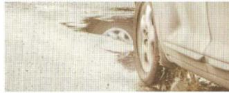
Después de haber salido de un charco o parte inundada, se recomienda que se frene dos o tres veces para secar los tambores y los discos. Para ello pisa el freno en repetidas ocasiones con el vehículo encendido.
