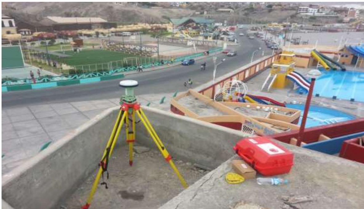
Antena GPS estacionada sobre un Punto Geodésico conocido, establecido por el Instituto Geográfico Nacional.
