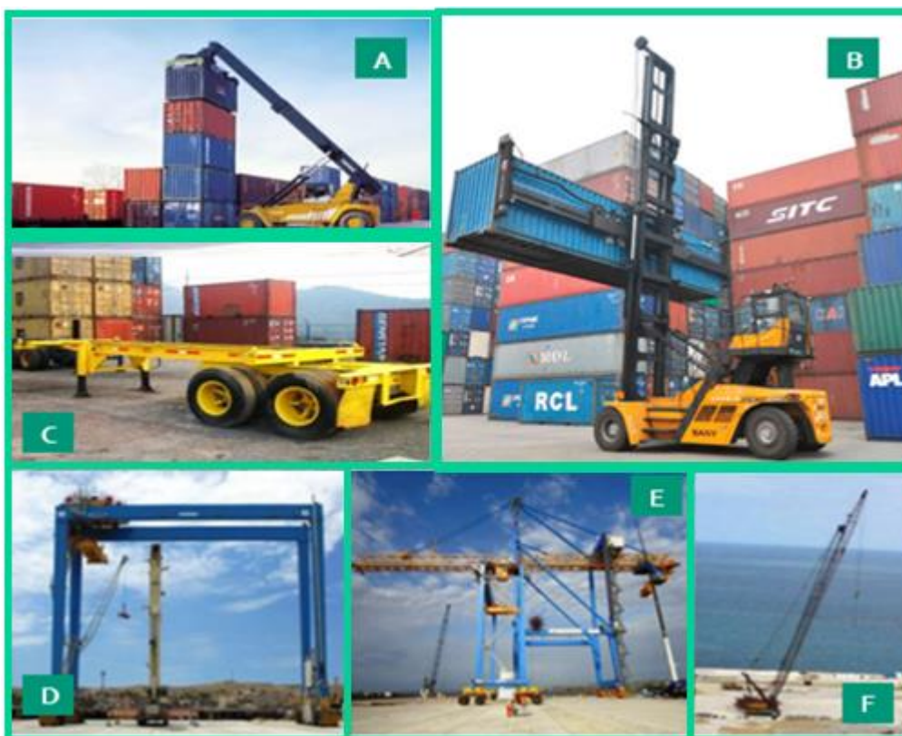
(A) Grúa Reach Stacker, (B) Elevador de contenedores vacíos, (C) Chasis para contenedores (D) Grúa pórtico de patio RTG, (E) Grúa pórtico de muelle STS (F) Grúa móvil de muelle. Fuente: Logismarket. Neptunia. Mota Engil.
