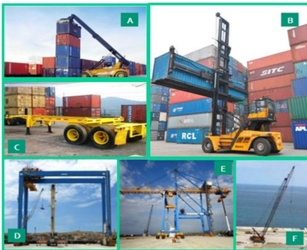
(A) Grúa Reach Stacker, (B) Elevador de contenedores vacíos, (C) Chasis para contenedores (D) Grúa pórtico de patio RTG, (E) Grúa pórtico de muelle STS (F) Grúa móvil de muelle.
