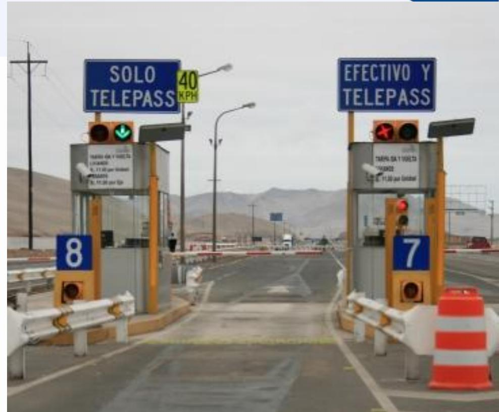
El Telepass consiste en el cobro de peaje de manera electrónica utilizando la tecnología RFID para realizar estas transacciones de manera rápida y segura, dando así comodidad al usuario en su viaje debido a que ya no tiene que detenerse en las casetas de cobro para realizar el pago del peaje.
